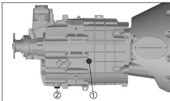
Уровень масла в коробке передач с фланцем должен быть по нижнюю кромку заливного отверстия, закрываемого пробкой 1. Уровень масла проверять через отверстие,
