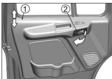
Изнутри замки дверей могут быть заблокированы нажатием на кнопки 1. При опущенных кнопках 1 двери нельзя открыть снаружи.
