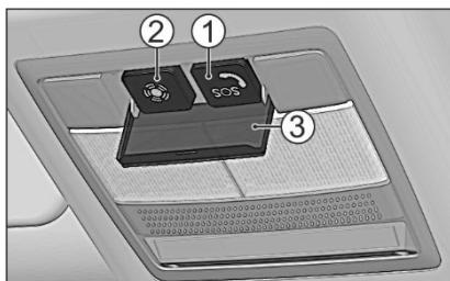
На отдельных комплектациях автомобиля кнопка 1 экстренного вызова SOS и кнопка 2 дополнительных функций расположены в блоке освещения салона и закрываются защитной крышкой 3. В блоке освещения салона также располагаются громкоговоритель и микрофон.
