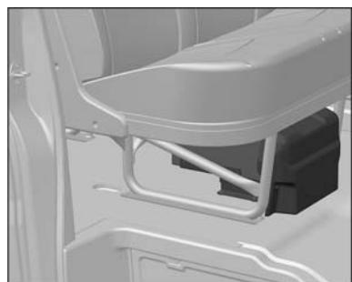
через радиатор дополнительного отопителя обеспечивает высокую интенсивность прогрева салона.
