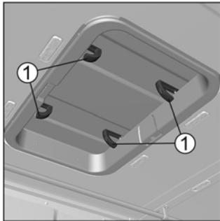
Чтобы приоткрыть люк для вентиляции салона надавите вверх на передние и/или задние ручки 1 крышки люка. Механизмы люка с пластиковой крышкой имеют два положения открытия – промежуточное и полное, механизмы люка со стеклянной крышкой имеют одно положение открытия.
