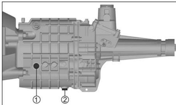
Уровень масла в коробке передач с удлинителем должен быть не ниже 7 мм от нижней кромки заливного отверстия, закрываемого пробкой 1. Уровень масла проверять через отверстие,
