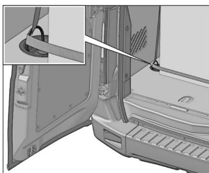
Для исключения перемещения груза на автомобилях с цельнометаллическим кузовом в грузовом салоне предусмотрена возможность крепления груза с помощью такелажных петель.
