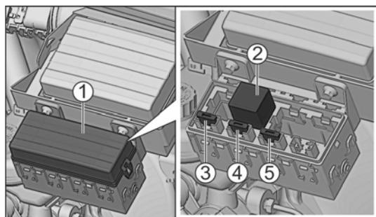
Под капотом, слева перед основным блоком реле и предохранителей на отдельном кронштейне расположен дополнительный блок реле и предохранителей. Для
