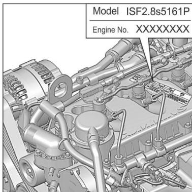
Идентификационный номер двигателя также продублирован на заводской табличке двигателя, расположенной на крышке клапанного механизма.
