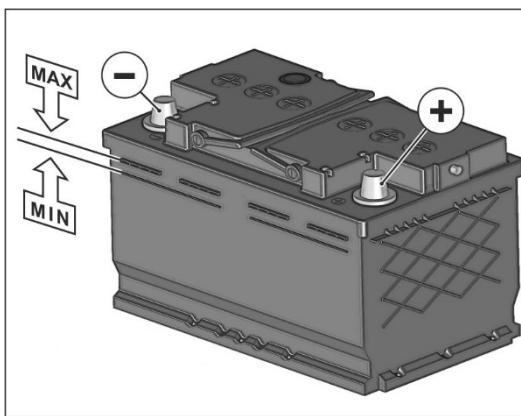
В нормальных условиях эксплуатации батарея почти не требует ухода. Однако, при высокой температуре наружного воздуха, рекомендуется регулярно проверять уровень электролита. Во всех секциях он всегда должен находиться между метками MAX и
