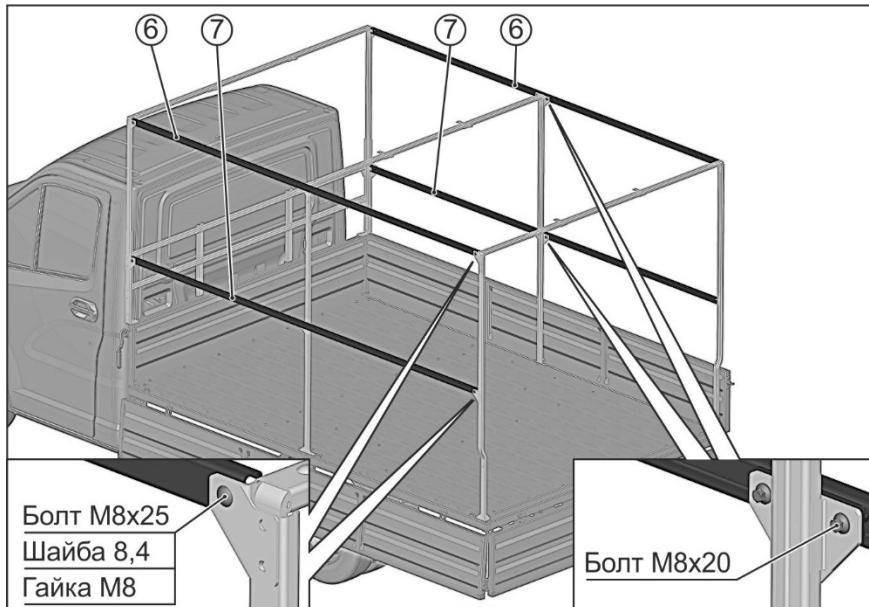
Установите верхние рейки дуг тента 6 и нижние рейки дуг тента 7, закрепив их болтами на передних, средних и задних стойках тента.
