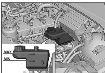
Уровень тормозной жидкости в полупрозрачном бачке главного тормозного цилиндра проверять визуально по меткам на корпусе бачка.
