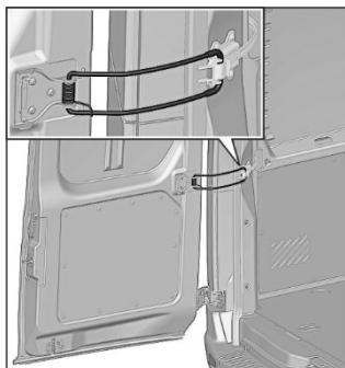
Задние двери открываются на  $270^\circ$  с фиксацией ограничителями при открывании на  $90^\circ$  (на автобусах ограничители не устанавливаются, задние двери открываются на  $180^\circ$  без фиксации при открывании на  $90^\circ$ ).
