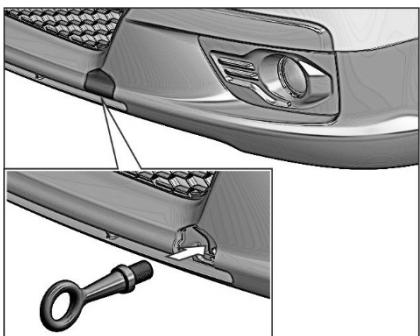
В передней части рамы к лонжеронам крепятся штампованно-сварные кронштейны. Левый кронштейн имеет приварную втулку, в которую при буксировке или вытаскивании застрявшего автомобиля необходимо ввернуть рым-болт для установки троса или цепи (рым-болт прикладывается к автомобилю).
