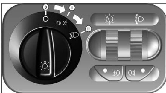
Переключатель имеет три фиксированных положения:
