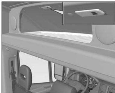
Для освещения внутреннего пространства над полкой для багажа в автомобилях с двухрядной кабиной предусмотрен плафон, включение/выключение которого осуществляется кнопкой. Освещение пространства над полкой в автомобилях с однорядной кабиной расположенным около боковой
