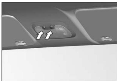
стороны водителя. Для выключения освещения повторно нажмите кнопку плафона.
