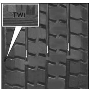
У основания протектора имеются «индикаторы износа» шин высотой 1,6 мм, расположенные поперек беговой дорожки протектора на одинаковом расстоянии по окружности. Местонахождение индикаторов износа показывает маркировка на боковине шины (например обозначение «TWI» или пиктограммы). Индикаторы износа
