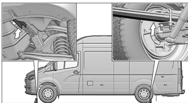
колеса (для замены заднего колеса). При подъёме колеса на грунте под основание домкрата рекомендуется подкладывать брусья или доску;
