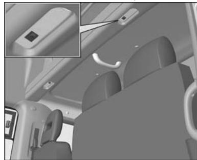
На автомобилях с цельнометаллическим кузовом и двухрядной кабиной плафоны внутреннего освещения второго ряда сидений расположены в накладке обивки крыши. Плафон имеет кнопку включения/выключения.
