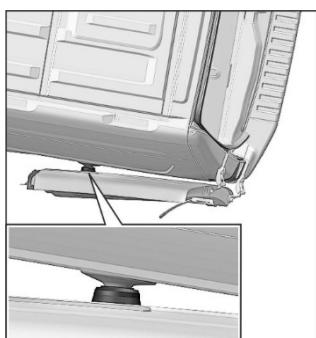
Фиксация при максимальном открывании двери ( $\sim 270^\circ$ ) осуществляется автоматически при помощи магнитного фиксатора. Для расфиксации потяните дверь в сторону закрывания (на себя).
