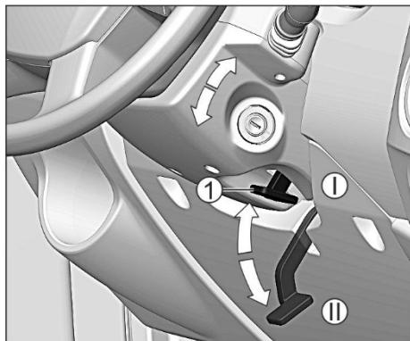
Рулевая колонка регулируется по углу наклона.
