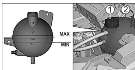
уровня охлаждающей жидкости в расширительном бачке 2 производите только на холодном двигателе.
