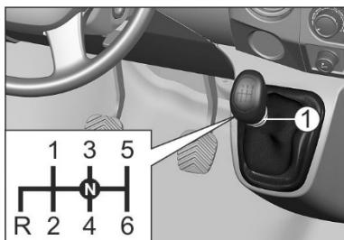
Рекомендации по переключению передач аналогичны 5-ступенчатой коробке передач. Для включения передачи заднего хода R поднимите блокирующее кольцо 1, расположенное под рукояткой
