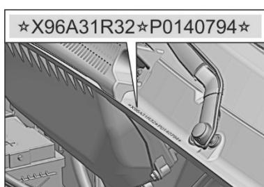
**Идентификационный номер ТС (VIN) на автомобилях с цельнометаллическим кузовом и их шасси** наносится под капотом на наружной передней панели передка с правой стороны по ходу движения.
