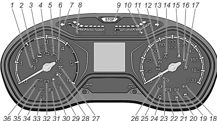
1. Сигнализатор (оранжевый) высокой температуры системы выпуска (для дизельного двигателя).
