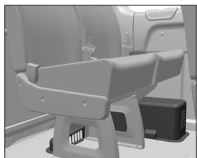
Независимый отопитель устанавливается под задним рядом пассажирских сидений. Для отопления салона используется внутренний воздух. Неоднократное прохождение внутреннего воздуха через теплообменник независимого отопителя обеспечивает высокую интенсивность прогрева салона.
