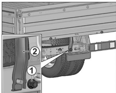
Запасное колесо, расположенное в задней части платформы, упирается в кронштейны, установленные на лонжеронах рамы, и закрепляется скобой на задней поперечине рамы. Для снятия запасного колеса отверните гайку 1 крепления колеса к скобе 2 и выньте колесо.
