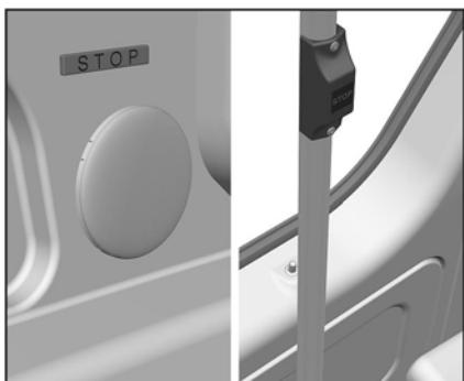
Автобус оснащается системой требования остановки, состоящей из светового табло «STOP» и специальной кнопки, расположенной на трубе поручня напротив сдвижной двери, для обеспечения требования пассажиров в салоне об остановке автобуса.
