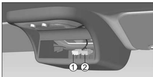
В случае отсутствия установки тахографа на предприятии-изготовителе для подключения тахографа к электрической цепи автомобиля имеются два электрических
