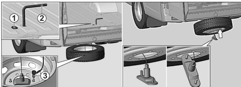
Запасное колесо размещено в заднем свесе и с помощью троса лебедки поджато к раме автомобиля.
