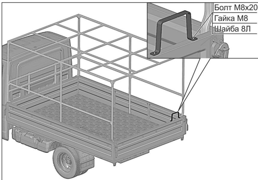
Установите подножку на задний борт платформы, закрепив ее болтами.
