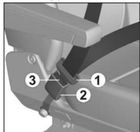
Для пристёгивания ремнём медленно (без рывков) потяните ленту ремня за язычок 1, чтобы её длина по груди и бёдрам была примерно одинаковой, и вставьте его в соответствующий данному сиденью замок 2 до характерного щелчка.
