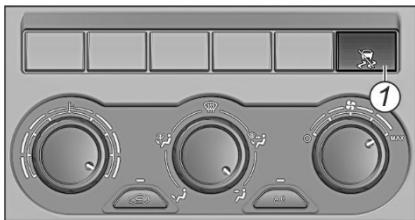
При необходимости движения с возможной пробуксовкой колес (например, движение на подъеме с поворотами, при наличии мокрого снега на дорожном покрытии) имеется возможность отключить ESP
