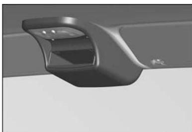
В потолочную консоль имеется возможность установить радиооборудование 1 DIN или тахограф.
