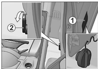
Для заправки топливом автомобиля с цельнометаллическим кузовом разблокируйте лючок 1 наливной горловины, повернув ручку 2 в направлении стрелки до отпирания замка лючка. При этом под действием пружины лючок
