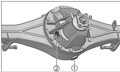
Уровень масла в заднем мосту должен быть по уровню нижней кромки заливного отверстия, закрываемого пробкой 2.
