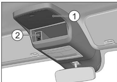
На отдельных комплектациях автомобиля в потолочной консоли находится футляр для очков 1, а также зарядное USB-устройство 2 (5В) на два разъема.
