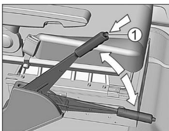
Для затормаживания автомобиля на стоянке стояночным тормозом плотно затяните рычаг, потянув его вверх. Для облегчения перемещения рычага одновременно нажмите на педаль тормоза. При стоянке на уклоне затягивайте рычаг по необходимости сильнее,
