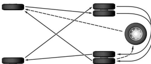
Перестановку колес рекомендуется производить через каждые 10000 км пробега (при необходимости) в соответствии с рисунком. Перестановка колес
