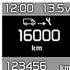
**Установка пробега до следующего ТО на комбинации приборов.**
