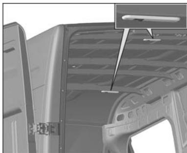
На автомобилях с цельнометаллическим кузовом освещение грузового салона осуществляется:
