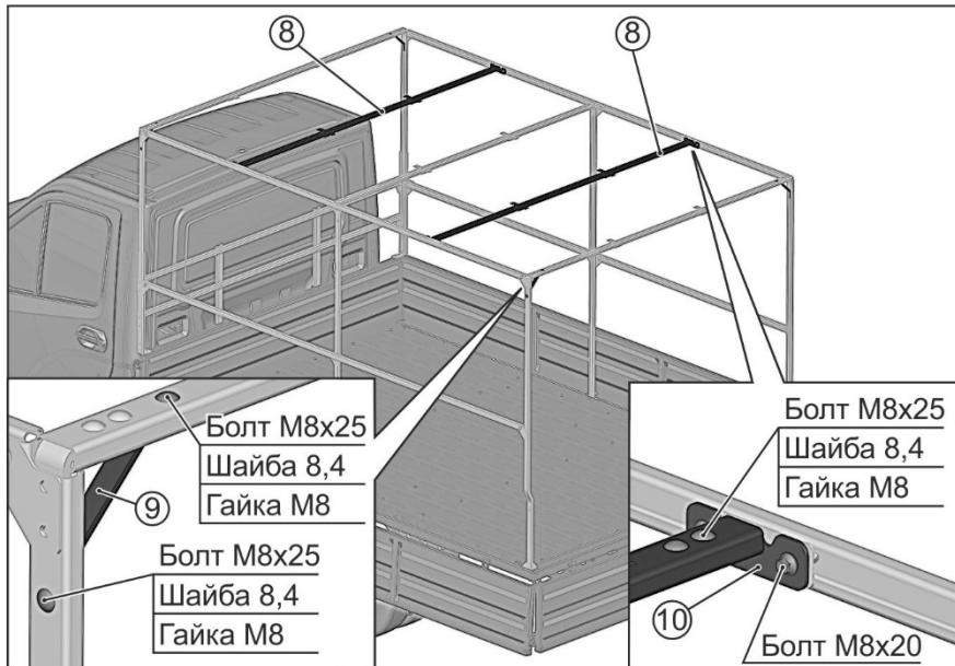
Соедините кронштейны поперечины 10 с верхними рейками дуг тента, закрепив их болтами.
