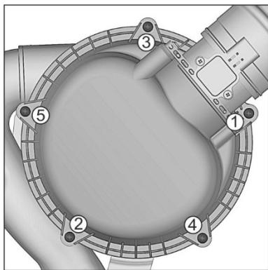
На некоторых модификациях автомобилей в конструкции крепления крышки воздушного фильтра к корпусу применяются винты. В этом случае после установки АКБ необходимо установить крышку воздушного фильтра на корпус и затянуть крепежные винты в последовательности, показанной на рисунке. Момент затяжки 2,8-3,5 Н м.
