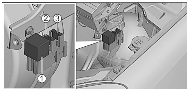
Под капотом рядом с блоком предохранителей на кронштейне расширительного бачка расположены главное реле 1, предохранители 2 и 3 номиналом 5А, защищающие датчики системы управления двигателем.
