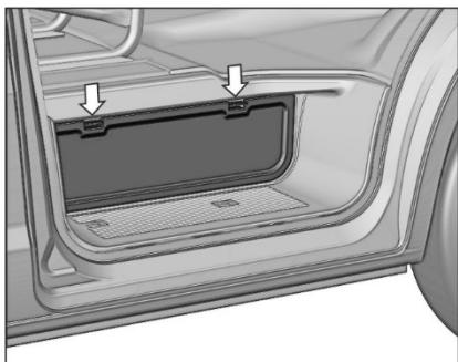
Комплект инструмента и домкрат упакованы в специальный вкладыш и размещены в отсеке подножки со стороны пассажира, закрываемом крышкой.
