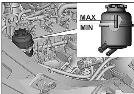
Уровень масла в бачке должен быть между метками, нанесенными на щупе крышки, обозначающими допустимый максимальный и минимальный уровень масла, при завернутой до упора крышке. Проверку уровня масла в бачке производите на
