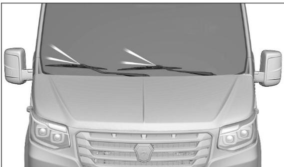
стеклоомывателя также может быть недостаточного напора струи воды, при необходимости прочистите отверстия жиклеров.
