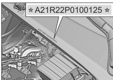
**Идентификационный номер кабины или цельнометаллического кузова** наносится под капотом на наружной передней панели передка с левой стороны по ходу движения.
