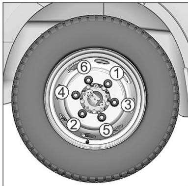
– затяните гайки крепления колеса моментом 30-38 кгс·м и уберите упоры. Затягивайте гайки не по кругу, а попеременно противоположные гайки, например, в порядке, показанном на рисунке;
